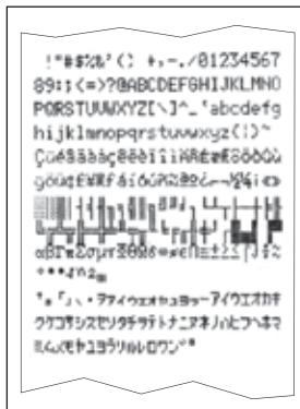
La impresora BT-P42 está equipada con una prueba de impresión que imprime automáticamente el carácter ajustado a la impresora.
