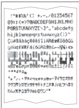
Der BT-P42 besitzt einen Selbst-Test, der automatisch den Zeichensatz des Druckers ausdruckt.
