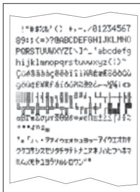
La BT-P42 è dotata di un self-test che stampa automaticamente i caratteri presenti sulla stampante.
