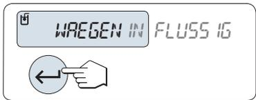
Die Waage fordert Sie auf, den Verdrängungskörper in der Flüssigkeit zu wägen "**WAEGEN IN FLUESSIGKEIT**".
