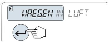
Die Waage fordert Sie auf, den Verdrängungskörper in der Luft zu wägen "**WAEGEN IN LUFT**".
