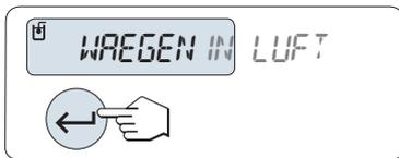
Die Waage fordert Sie auf, den Festkörper in der Luft zu wägen "**WÄGEN IN LUFT**".
