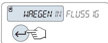
Die Waage fordert Sie auf, den Festkörper in der Hilfsflüssigkeit zu wägen "**WÄGEN IN FLÜSSIGKEIT**".
