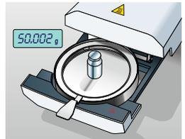
**校正:** 对测定仪器进行调整获得正确测定: 首先记录测定值和真实值之间的偏差(校准), 并进行修正。
