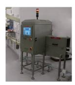
自动化的 X 射线检测技术越来越受到 食品加工行业的青睐,这是因为它与其 他类型的检测技术相比具有更加卓越的 优越性。它还完善和扩展了现有的技术, 例如运用了其他多种检测功能的传统的 金属检测和运用其它多种检测功能的重 量检测。该技术透过包装内产品的横截 面来测量 X 射线的吸收量。吸收量与产 品的厚度、密度和化学成分有关。这样就 可以检测到不易看透的污染物,以及产 品瑕疵。
