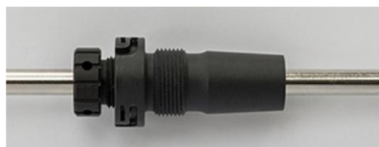
12 Fissare l'albero dell'agitatore serrando il mandrino (3) e fissandolo con il dispositivo di bloccaggio (1) sopra il mandrino (3) (il dispositivo di bloccaggio impedisce all'albero dell'agitatore di cadere nel reattore nel caso in cui il mandrino venga allentato inavvertitamente o per errore).
