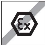
La plate-forme de pesage ne doit être utilisée que dans des locaux fermés. L'utilisation dans un environnement à risque d'explosions n'est pas autorisée.
