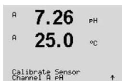
Sélectionnez l'étalonnage en un point. Avec les électrodes de pH, un étalonnage en un point est toujours réalisé comme un étalonnage du décalage.
