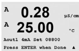
Lorsque le nombre à cinq chiffres augmente, le courant en sortie augmente également et lorsque le nombre diminue, le courant en sortie suit la même évolution. Par conséquent, des changements grossiers peuvent être apportés au courant de sortie en modifiant les chiffres des centaines et des milliers ; des changements précis peuvent être effectués en modifiant les chiffres des dizaines et des unités.
