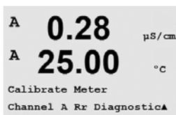
L'étalonnage Diagnostic Rr s'effectue en deux points. Accédez à l'écran Calibrer Transm. et sélectionnez le canal A et Diagnostic Rr.
