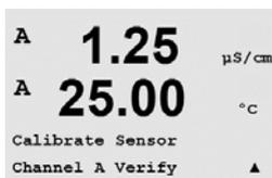
Accédez au mode d'étalonnage comme indiqué à la section 7.1. « Accès au mode Calibrage », puis sélectionnez Vérifier.
