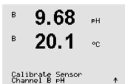
Accédez au mode Calibrage pH comme indiqué à la section 7.1 « Accès au mode Calibrage ».
