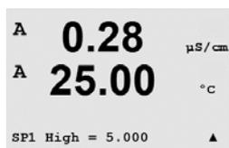
En fonction du type de seuil défini, cet écran propose l'option permettant d'ajuster les valeurs au(x) seuil(s).
