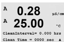
L'intervalle du cycle de nettoyage peut être réglé de 0,000 à 999,9 heures. Un réglage sur 0 désactive le cycle de nettoyage. La durée du nettoyage peut être définie de 0 à 9 999 secondes et doit être inférieure à l'intervalle du cycle de nettoyage.
