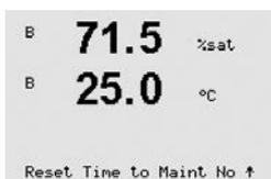
Si une électrode de pH est connectée, le menu de réinitialisation du délai de maintenance s'affiche. Le délai de maintenance doit être réinitialisé après les opérations suivantes.
