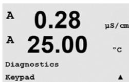
Pour le diagnostic du clavier, la touche activée est précisée sur l'écran. Appuyez sur la touche [ENTER] pour que le transmetteur revienne au mode de mesure normal.
