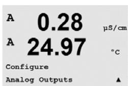
Accédez au mode Configuration comme indiqué à la section 8.1. « Accès au mode Configuration » et naviguez jusqu'au menu « Sorties courant » à l'aide de la touche ▲ ou ▼
