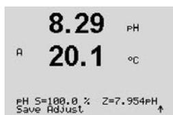
Pour les sondes ISM (numériques), sélectionnez AJUSTER, ÉTALONNER ou ANNULER pour terminer l'étalonnage. Pour les sondes analogiques, sélectionnez AJUSTER ou ANNULER pour terminer l'étalonnage. Voir 7.1.2 « Fin de l'étalonnage ».
