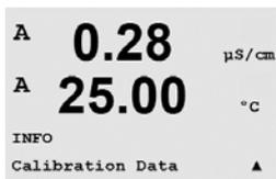
La sélection de Données d'étalonnage permet d'afficher les constantes d'étalonnage pour chaque sonde.
