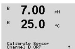
Accédez au mode d'étalonnage redox comme indiqué dans la 7.1 « Accès au mode Calibrage ».
