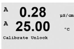
Sélectionnez Oui pour que les menus d'étalonnage de l'instrument et des sorties courant soient accessibles sous le menu CAL. Si vous sélectionnez Non, seul l'étalonnage de la sonde sera disponible dans le menu CAL. Après la sélection, appuyez sur [ENTER] pour afficher un message de confirmation.
