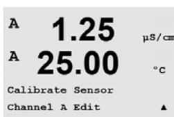
Accédez au mode d'étalonnage comme indiqué à la section 7.1 « Accès au mode d'étalonnage », puis sélectionnez Modifier, Modifier pH ou Modifier mV.
