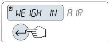
Die Waage fordert Sie auf, den Festkörper in er Luft zu wägen **"WEIGH IN AIR"**.
