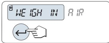
Die Waage fordert Sie auf, den Verdrängungskörper in der Luft zu wägen **"WEIGH IN AIR"**.
