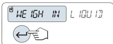
Die Waage fordert Sie auf, den Verdrängungskörper in der Hilfsflüssigkeit zu wägen **"WEIGH IN LIQUID"**.
