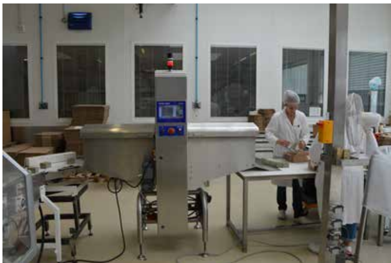
X33 X 射线系统在 Laboratoires BEA 生产线末端检测制造的香皂，然后再分发到全球各地市场。
