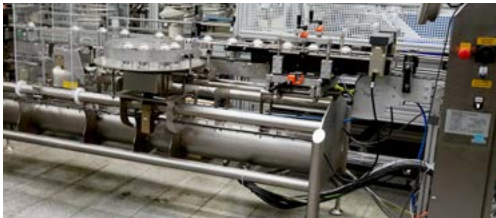
Cân kiểm tra dạng xích mang lại độ ổn định tối đa và kết quả cân chính xác nhất.
