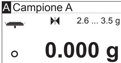
Sull'indicatore compare il peso nominale del campione stabilito per il metodo utilizzato (in questo esempio per il "Campione A"). Questo peso nominale non influenza il processo di misura ma serve solo da ausilio per il dosaggio. Per ottenere risultati il più possibile riproducibili, la quantità di campione deve rispettare le tolleranze del peso nominale.
