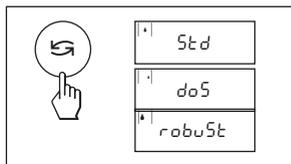
En esta posición la balanza se ajuste al modo pesada. Seleccione "Std" (estándar) para todas las operaciones de pesada normales. En "doS" (dosificar), para la dosificación de productos líquidos o en forma de polvo, la balanza reacciona muy rápido a la mínima variación de peso. En "robuSt" (pesada absoluta), la balanza sólo reacciona ante grandes variaciones de peso, el resultado de pesada es muy estable.
