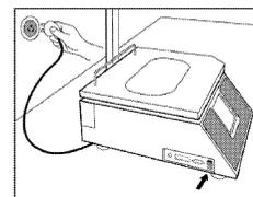
Извлеките сетевой кабель из упаковочной коробки. Подключите сетевой кабель к разъему, расположенному в нижней части весов. (Если весы хранились или транспортировались при отрицательных температурах, перед подключением к сети необходимо дать им прогреться до комнатной температуры). Подключите сетевой кабель к розетке сети переменного тока. Установите сетевой выключатель в положение **ON**. Перед началом настройки весы должны прогреться не менее 30 минут.
