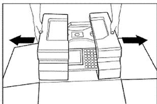
Вскройте упаковочную коробку. Сначала извлеките весовую крышку, затем — весы. Удалите пенопластовые вставки и пластиковый пакет. Установите весы на прилавок.
