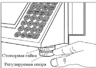
С помощью регулируемых опор выровняйте весы, чтобы пузырек располагался точно по центру уровня. Зафиксируйте опоры в установленном положении с помощью стопорных гаек.
