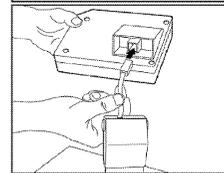
Присоедините кабель, выходящий из основания выносного индикатора, к разъему на верхнем конце стойки.
