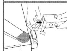
Соедините разъем кабеля нижнего конца стойки с кабелем, выходящим из металлического основания выносного индикатора. Для удобства соединения снимите крышку снизу металлического основания выносного индикатора (для этого выкрутите винты).
