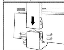
Вставьте выносной индикатор в металлическое основание и закрепите его винтами.
