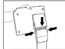
Нажмите на кнопки фиксаторов, расположенных по бокам основания выносного индикатора, и установите его стойку.
