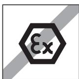
La balanza sólo puede utilizarse en espacios cerrados. No se permite su utilización en áreas expuestas a explosiones.
