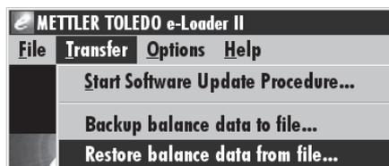
Para transferir la configuración actual del PC a la balanza, seleccione la función de recarga, tal y como se indica en la ilustración de la izquierda.
