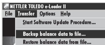
Para proteger la configuración actual de la balanza en un PC, inicie el cargador e-Loader II y seleccione la función de copia de respaldo, tal como se indica en la ilustración de la izquierda.
