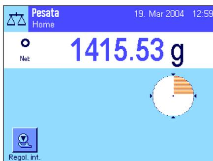
**Pesare:** Porre il materiale da pesare sulla bilancia. Non appena scomparirà il simbolo di controllo stabilità (il piccolo anello a sinistra dell'indicazione del peso), l'indicazione sarà stabile e sarà possibile rilevare il risultato della pesata. Nell'illustrazione qui accanto il simbolo del controllo stabilità è ancora visibile e di conseguenza il risultato della pesata non è ancora stabile.
