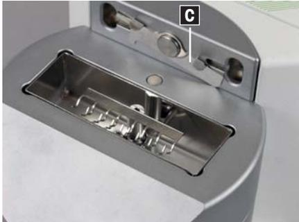
**Transportsicherung entfernen:** Verriegelungswippe (C) des Wägekammer-Deckels nach rechts kippen und Wägekammerdeckel nach vorne wegziehen. Transportsicherung vorsichtig entfernen (Schaumstoffkissen mit Klebeband), anschliessend Wägekammer-Deckel wieder einsetzen und verriegeln.
