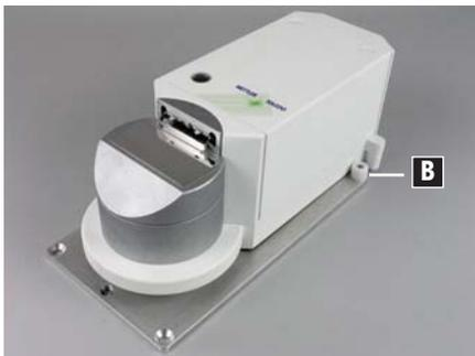
**Wägezelle** in die Positionierungsplatte einsetzen. Sicherstellen, dass der vordere Standfuss der Wägezelle in der kreisförmigen Bohrung liegt. Die Wägezelle muss spielfrei zwischen den beiden weissen Kunststoffbuchsen (B) liegen. Zur präzisen Positionierung können Sie die Befestigungsschrauben der Kunststoffbuchsen lösen, die beiden Buchsen an die Wägezelle schieben und die Schrauben wieder anziehen.
