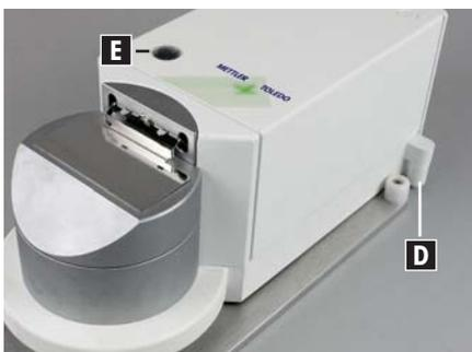
**Wägezelle nivellieren:** Die beiden Fusschrauben (D) hinten am Gehäuse drehen, bis sich die Luftblase im Zentrum der Libelle (E) befindet.
