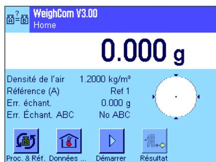
Après sélection de l'application, la fenêtre principale de l'application apparaît. D'origine, les touches de fonction spéciale et les champs d'information pour l'application "WeighCom" sont activés. Ceux-ci et d'autres paramètres peuvent être adaptés à vos besoins, conformément à la description dans les chapitres suivants.
