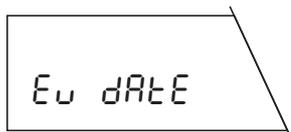
Le sixième sous-menu vous permet de sélectionner soit la présentation européenne (réglage d'origine), soit la présentation américaine de la date. Si une imprimante METTLER TOLEDO est raccordée, la date et l'heure sont imprimées dans le format sélectionné.
