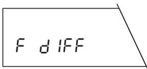
Dans le premier sous-menu, vous sélectionnez la **fonction «F diff»** si vous souhaitez effectuer des pesées différentielles. Pour le pesage normal, sélectionnez «F none» (réglage d'origine).
