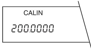
Al poco tiempo suena la señal acústica, y en el indicador aparece la pesa de ajuste exigida que depende del modelo, por ejemplo, 200 g.
