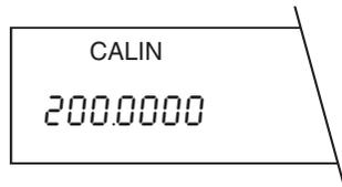
Le signal sonore d'avertissement retentit peu de temps après et sur l'affichage apparaît le poids de calibrage demandé en fonction du modèle de la balance, par exemple 200 g.
