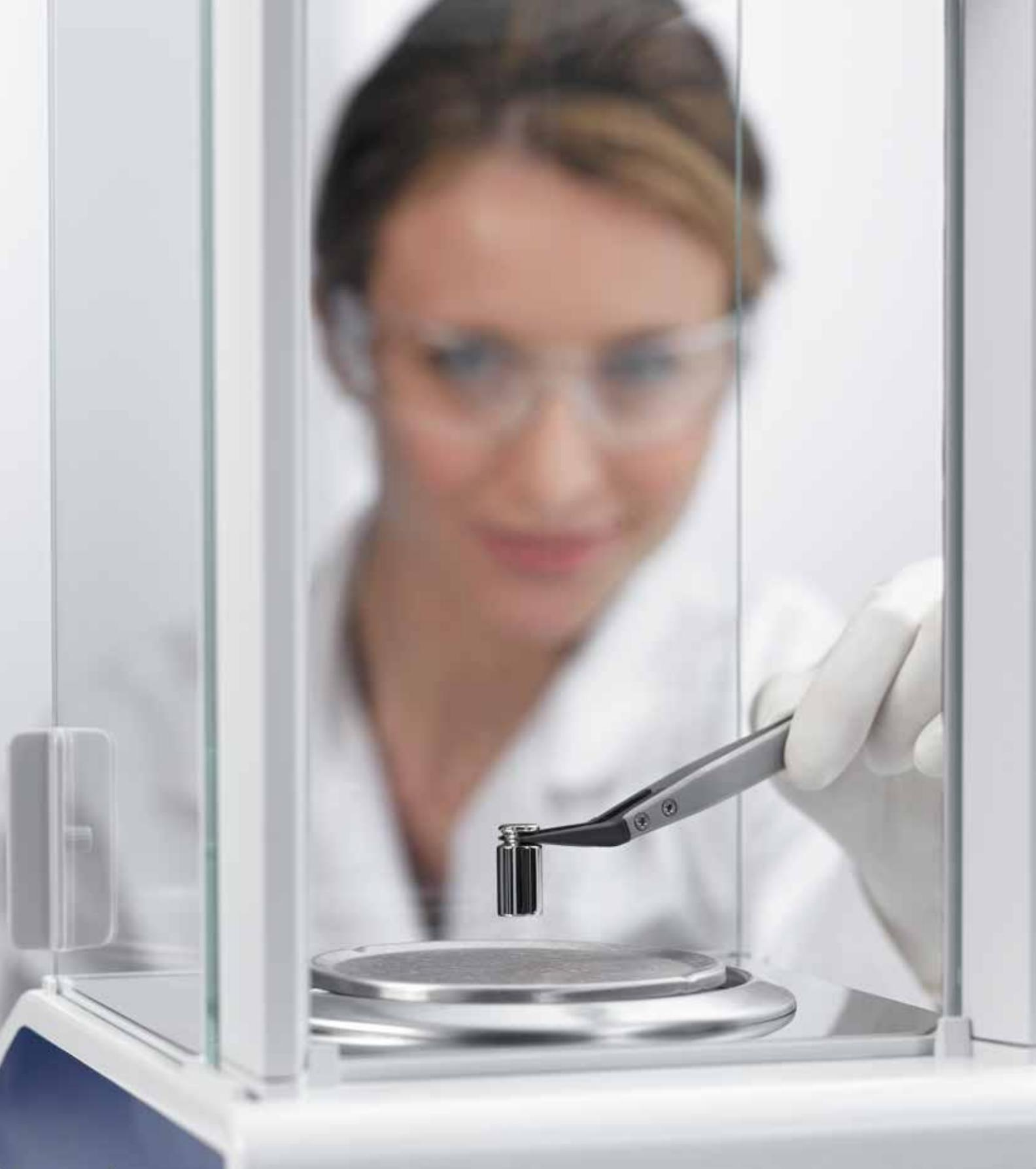
La función ISO-Log integrada proporciona una completa trazabilidad de todos los ajustes de peso relevantes para su balanza. Todos los cambios realizados en las comprobaciones periódicas o a través de FACT se registran automáticamente.
