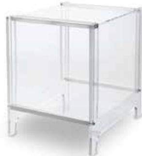
La pantalla de protección resguarda la balanza de las corrientes de aire que pueden impedir la estabilización de la balanza, como las del aire acondicionado.
