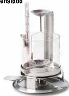
La determinación de la densidad de muestras sólidas y líquidas resulta sencilla con este kit para balanzas de precisión y analíticas.
