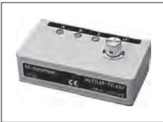
Für den Anschluss von max. 3 Waagen mit LocalCAN Schnittstelle an einen Drucker
