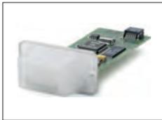
BT Option: Bluetooth-Schnittstelle, kabellose Verbindung für bis zu 6 verschiedenen Geräten
