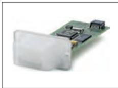
BTS Option: Bluetooth-Schnittstelle, Einpunktanschluss
