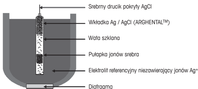
Rysunek 17. Schematyczne przedstawienie systemu referencyjnego ARGENTHAL™.
