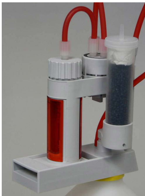
Obrázek 33: Patrona naplněná NaOH na nosiči, která brání absorpci CO 2 titrantem
