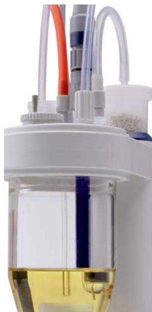
Obrázek 21: Na pravé straně fotografie je vidět hadička spojující titrační celu a sušicí patronu; tímto uspořádáním je zajištěno, že v systému nevzniká žádný přetlak
