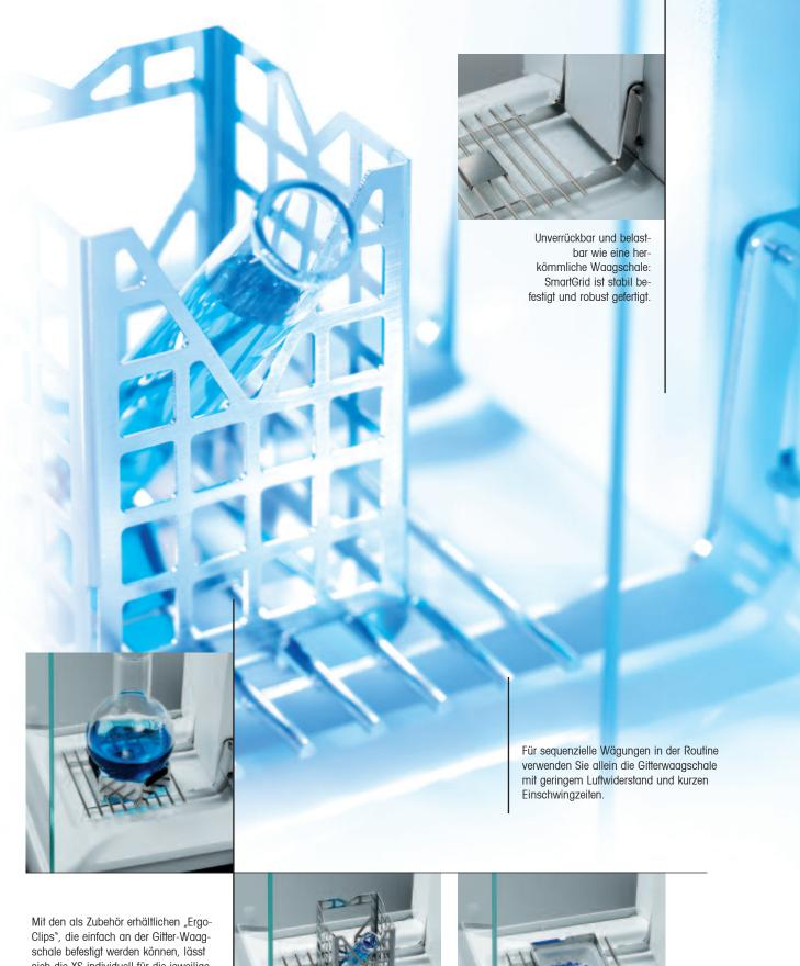
Mit den als Zubehör erhältlichen "Ergo-Clips", die einfach an der Gitter-Waagschale befestigt werden können, lässt sich die XS individuell für die jeweilige Wägeaufgabe einrichten. ErgoClips, die Aufsätze für Rundkolben, Reagenzgläser und Plastikröhrchen sowie Einmal-Wägeschalen, vereinfachen spezifische Wägeaufgaben enorm.
