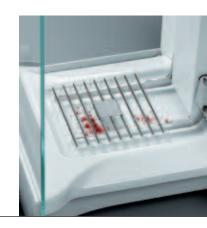
Fällt beim Dosieren Substanz neben das Gefäss, verfälscht dies das Wägeresultat nicht länger. Dank Gitterwaagschale fällt die Substanz einfach in die darunter liegende Schale.
