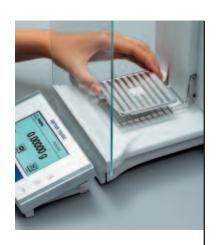
Wünschen Sie eine durchgehende Auflagefläche, legen Sie die Chromstahl-Waagschale auf den SmartGrid. Arbeiten Sie mit toxischen Substanzen, verwenden Sie die Einweg-Aluschale und entsorgen die Aluschale nach der Wägung.
