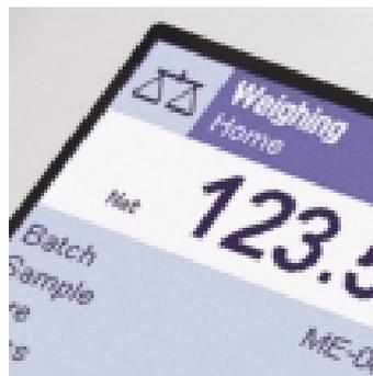
状态显示：SmartScreen 智能彩色触摸屏上绿色明亮的图符提示显示了 SmartSense 红外感应器所激活的功能：打印、去皮、回零、开关门等。
