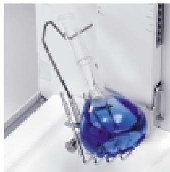
去皮容器吸附静电荷会影响称量结果，您可以通过使用 ErgoClip 选件中的金属篮有效消除静电荷的影响。
