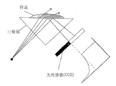
由RE40发出的光透过棱镜到达被测溶液,光部分折射(入射角<临界角),部分反射(入射角>=临界角),用光传感器(CCD)记录,反射光黑色和白色区域的分界线代表计算折射率用的临界角。
