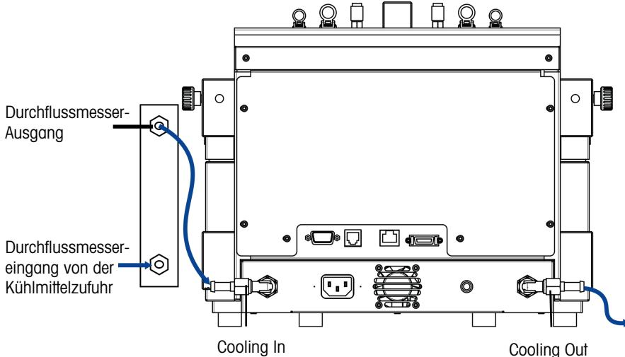
Das Gerät wird mit zwei PVC-Industrieschläuchen geliefert. Wenn Sie den Durchflussmesser verwenden, benötigen Sie ein drittes Stück, das von einem der gelieferten Schläuche abgeschnitten werden kann.
