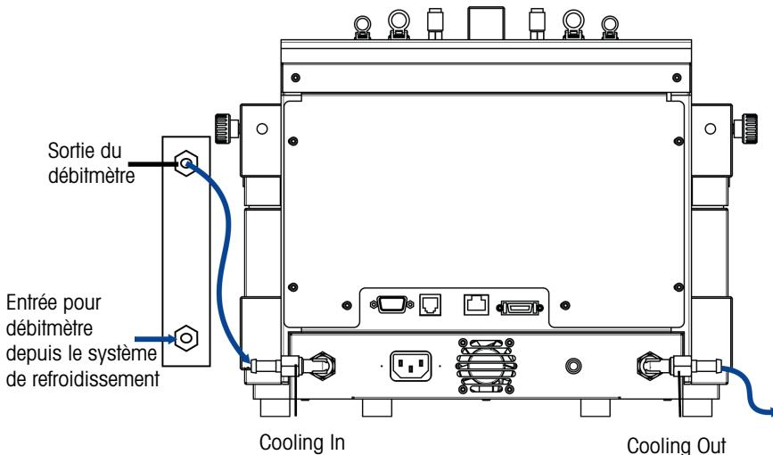
L'instrument est livré avec deux flexibles industriels en PVC. Si vous utilisez le débitmètre, vous aurez besoin d'un troisième morceau de flexible qui peut être coupé à partir d'un des flexibles livrés.
