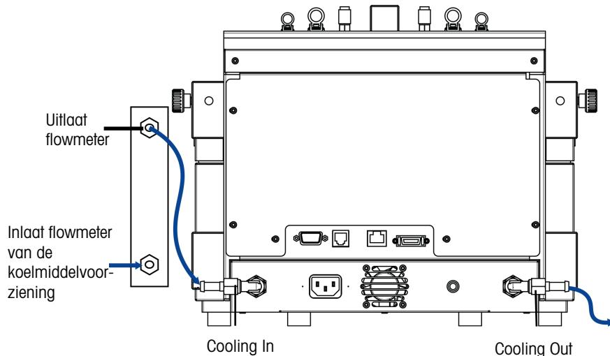
Het instrument wordt geleverd met twee industriële pvc-slangen. Als u de flowmeter gebruikt, hebt u een derde slang nodig die u van een van de geleverde slangen kunt afsnijden.
